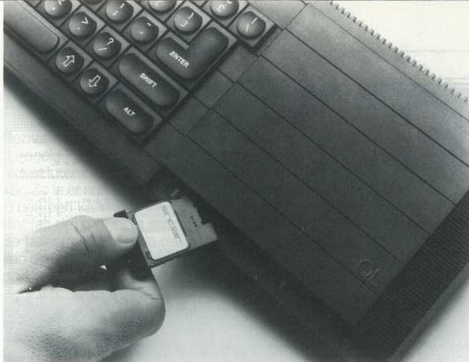
Fig. 4: De zeer kleine microdrive; introduceert Sinclair een nieuwe standaard?
