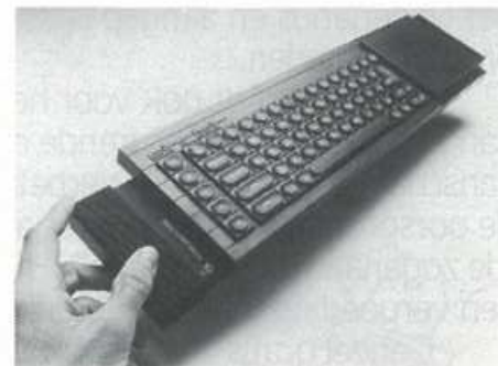
Fig. 3: Een prototype van het 0.5 Mbyte geheugen-board.
