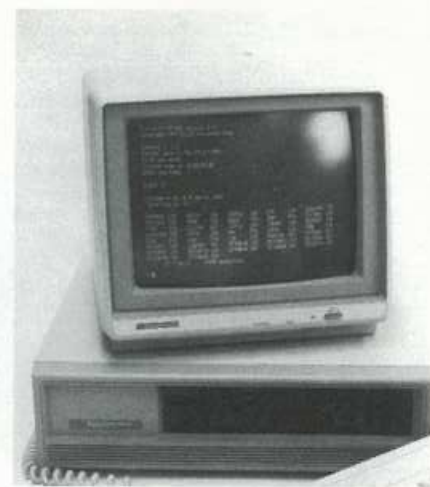
Fig. 4: Het beeldscherm van de TI is in een aparte behuizing ondergebracht en biedt een prima resolutie.
